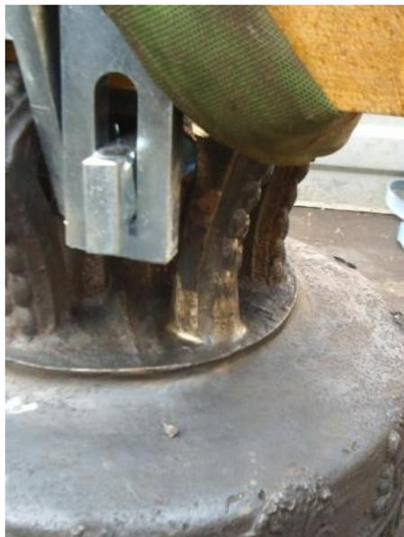
An der hellen Bronze erkennt man, dass hier einer der Kronenarme neu angeschweißt wurde. Möglicherweise ist der alte Arm bei der Demontage im 2. Weltkrieg abgebrochen oder beim anschließenden Transport. Denn unser „Stummala“ sollte, wie so viele andere Glocken auch, in ein Kanonenrohr umgegossen werden ...
